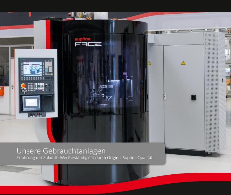
Rundtakt-Maschine für die Planfinish-Bearbeitung
